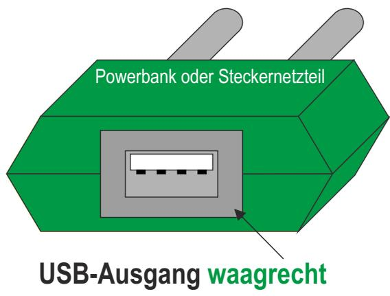
Platzierung des USB-Steckers für waagrecht USB-Ausgang:
