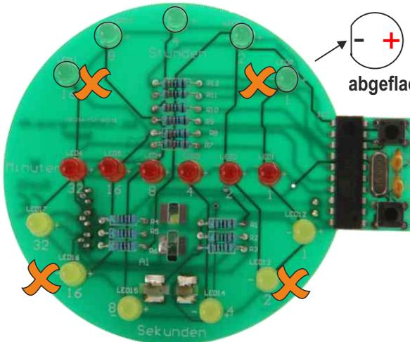
**ACHTUNG:** alle LED's müssen nach dem Löten flach auf der Platine aufliegen. Hierzu die 4 gekennzeichneten LEDs **X** auflöten und erst danach die anderen. Beim Löten darauf achten, dass kein Kurzschluss zwischen den Beinchen entsteht! Ein Kurzschluss entsteht dann, wenn z.B. unbeabsichtigt 2 Drähte mit Lötzinn zusammengelötet werden.
