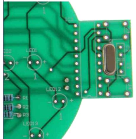
**H** Prozessor und 2 Taster auflöten. Nur beim Prozessor musst Du auf die Polung achten. Dieser hat eine Einkerbung (Rundung) und daran erkennst Du die Ausrichtung. Siehe Zeichnung in rot! Überstehende Drähte kürzen.
