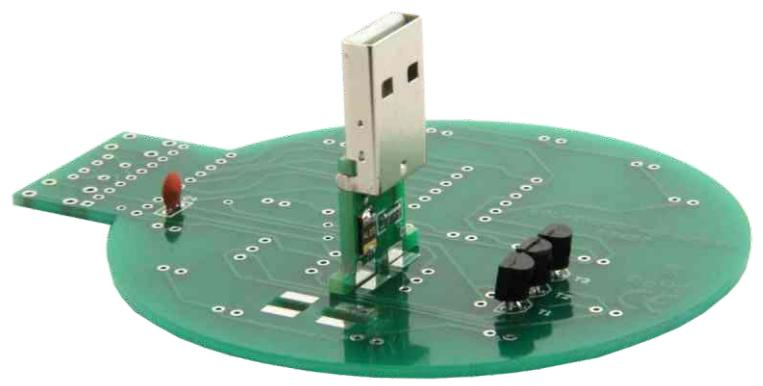
**D** Nach der Wahl der richtigen Platzierung kann der USB-Stecker eingelötet werden. Achte dabei darauf, dass der USB-Stecker bis zum Anschlag in die Platine eingeschoben ist. Erst nur eine Lötstelle leicht anlöten, USB-Stecker ausrichten (wenn dieser schräg steht) und dann die restlichen 3 Lötstellen anlöten. Nur wenn alle 4 Lötstellen gelötet wurden, ist eine gute Stabilität des USB-Steckers gewährleistet.
